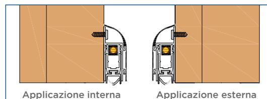
• **CARATTERISTICHE** Meccanismo con una singola regolazione (vite F : discesa) caratterizzato dal movimento controllato del profilo mobile con guarnizione (discesa immediata dal lato cerniere della porta e conseguente discesa graduale per tutta la lunghezza) per un adeguamento al pavimento.
